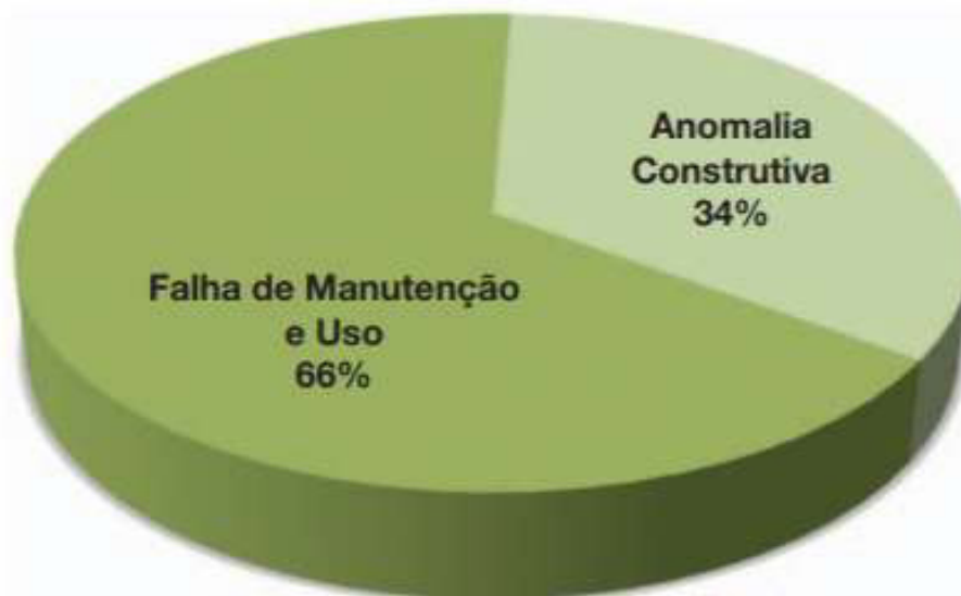
Figura 1 - Incidência dos acidentes prediais por origem em São Paulo
