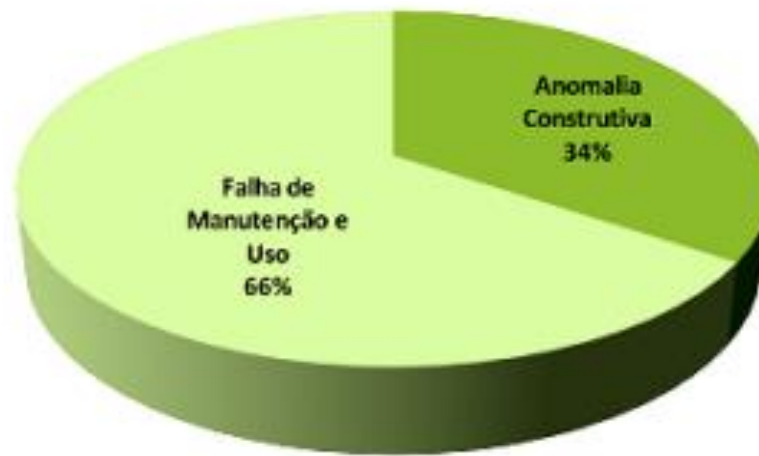
Figura 2 – Causas de acidentes nas edificações do estado de São Paulo
