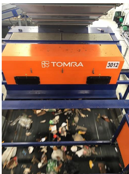
Figura 39 – Separador óptico do Ecoparque Pernambuco.
