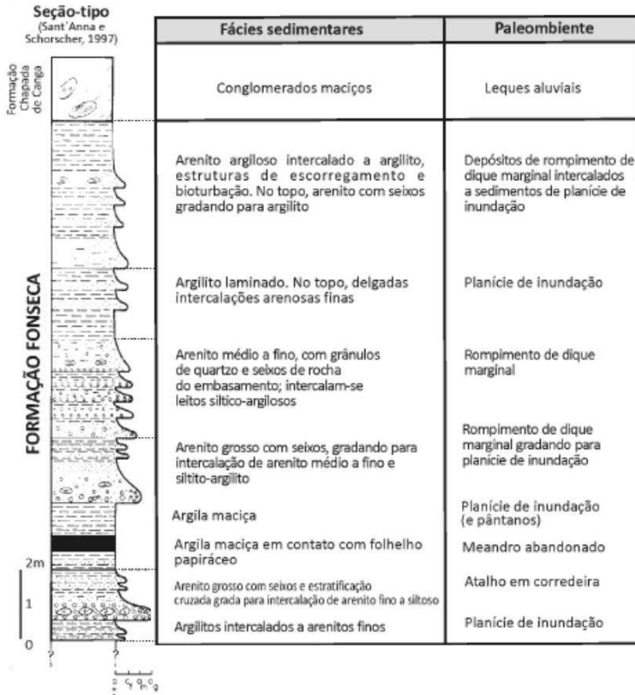
Figura 7 – Seção colunar tipo da Formação Fonseca levantada por Sant'Anna e Schorsch (1997)
