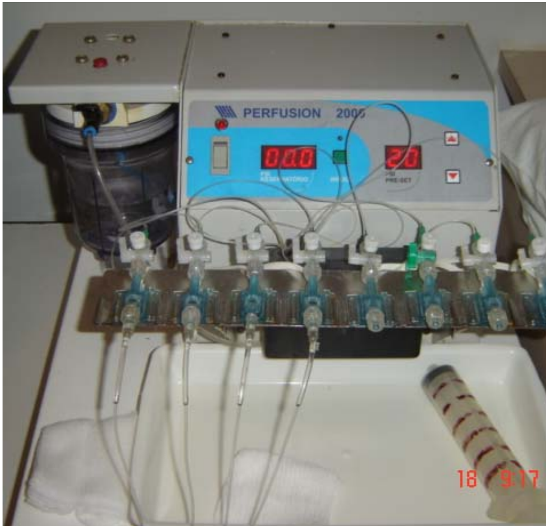
Figura 19 - Bomba perfusora pneumo-hidráulica, reservatório com capacidade para 1,2l, um cateter radial com quatro canais e uma seringa 60ml.
