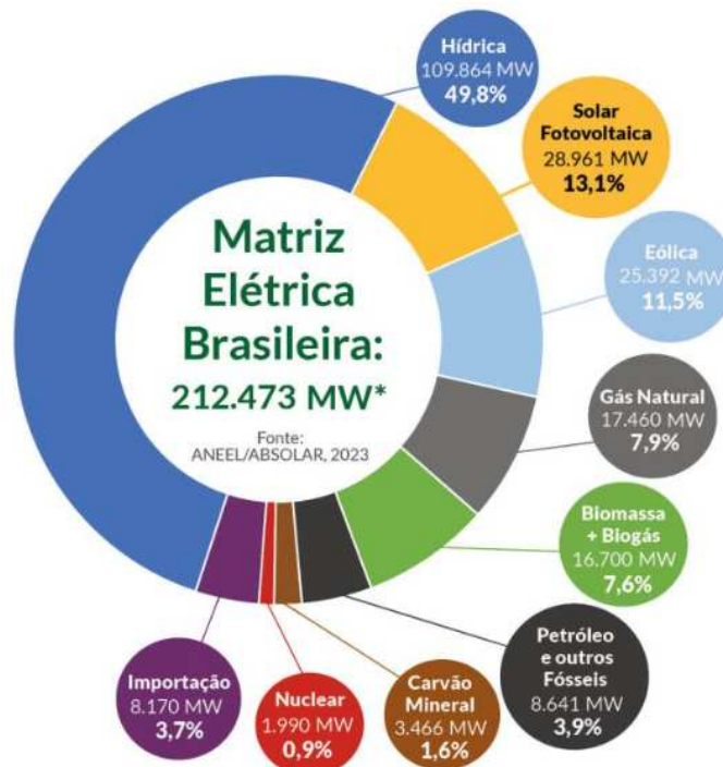
Figura 4 – Potência instalada em operação no Brasil
