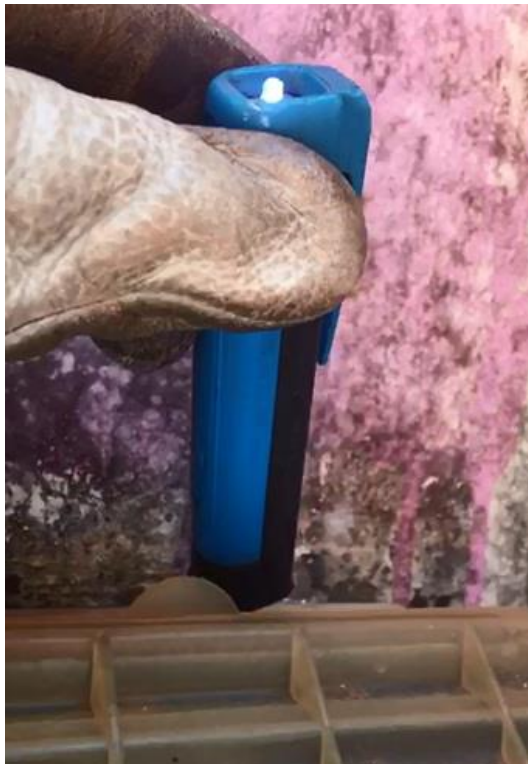
Figura 166 - 1º Fraude detectada por intervenção de ímã no medidor durante teste de protótipo.
