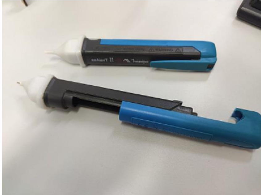
Figura 155 - Dispositivos ezAlert defeituosos para uso no protótipo.
