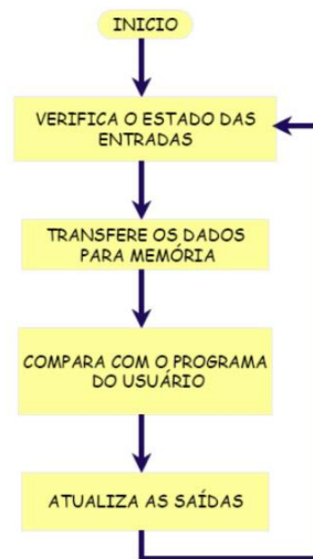
Figura 1 – Fluxograma esquemático do funcionamento de um CLP
