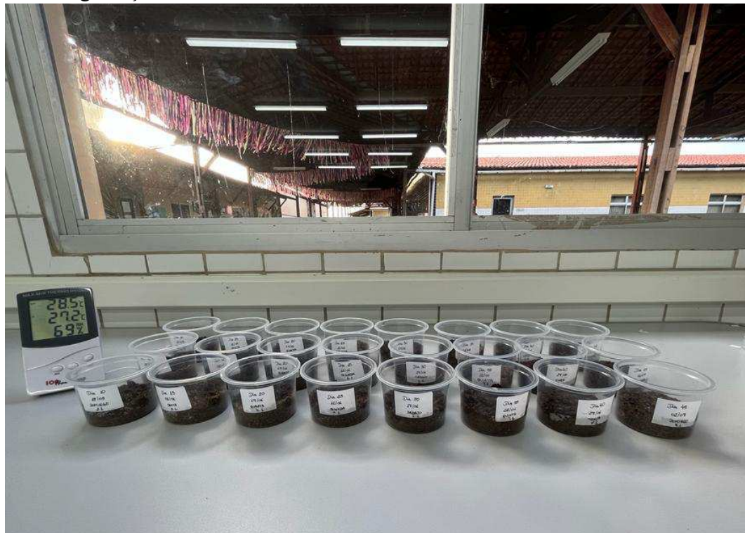
Figura 6 - Recipientes contendo os canudos submersos no solo simulado para o teste de biodegradação
