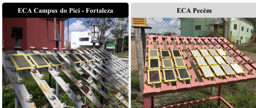
Figura 14 - Amostras revestidas expostas nas Estações de Corrosão Atmosférica.
