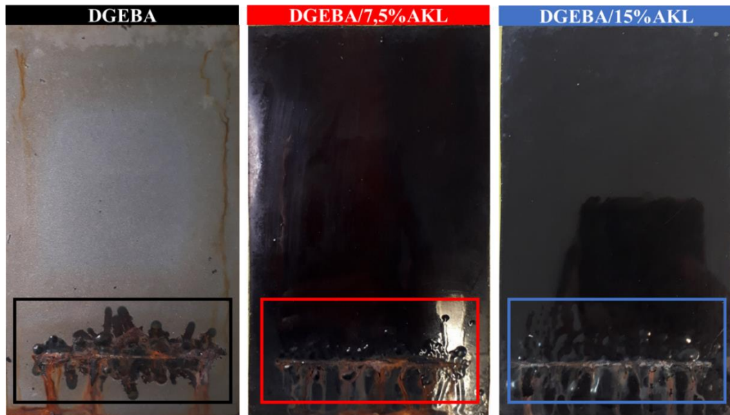
Figura 36 - Aspecto visual das amostras revestidas após 42 dias de ensaio de névoa salina.
