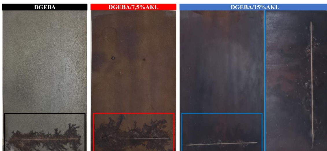
Figura 56 - Aspecto visual das amostras revestidas após 24 meses de ensaio de corrosão atmosférica (marinha-industrial).
