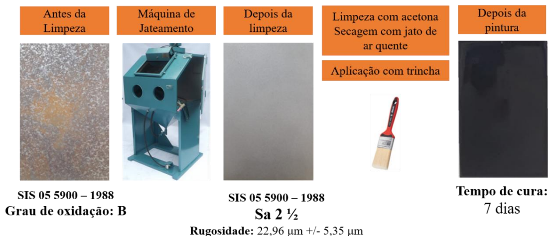
Figura 10 - Preparação da superfície e pintura dos substratos metálicos.
