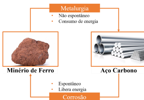
Figura 01 - Ciclo de produção e degradação do aço carbono.
