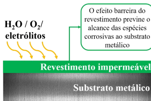
Figura 03 - Mecanismo de proteção contra corrosão por barreira.
