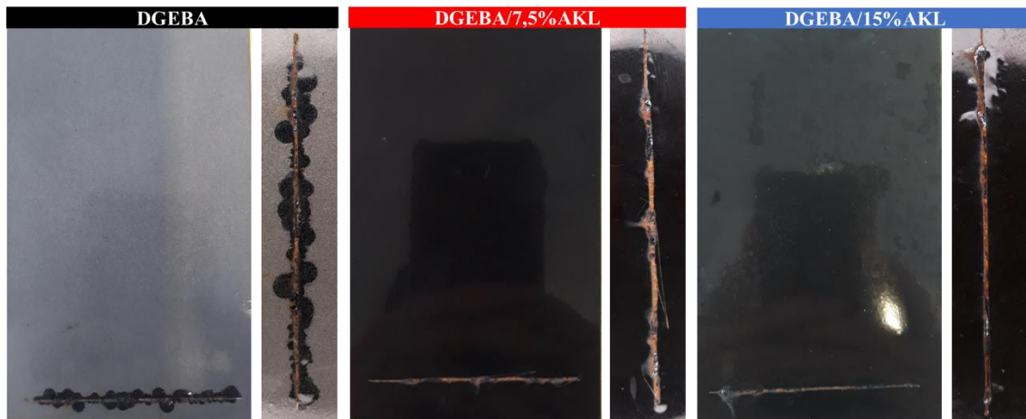
Figura 41 - Aspecto visual das amostras revestidas após 42 dias de ensaio de umidade saturada.
