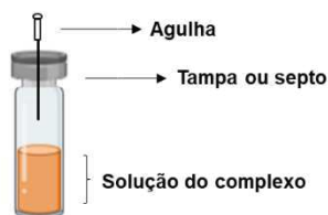
Figura 11 - Representação do método de crescimento de cristais para o complexo I.
