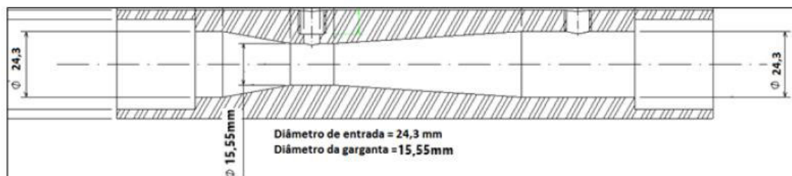
Figura 9 – Medidas internas do tubo Venturi.
