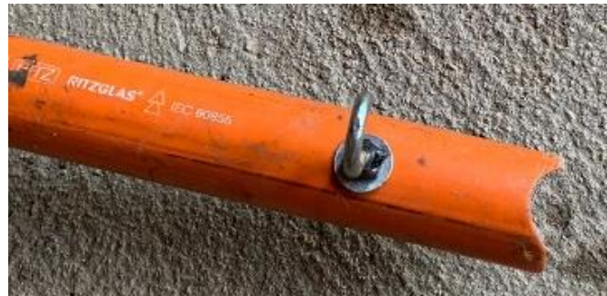
Figura 11 - União Gancho-Parafuso M10 parafusado na Vara
