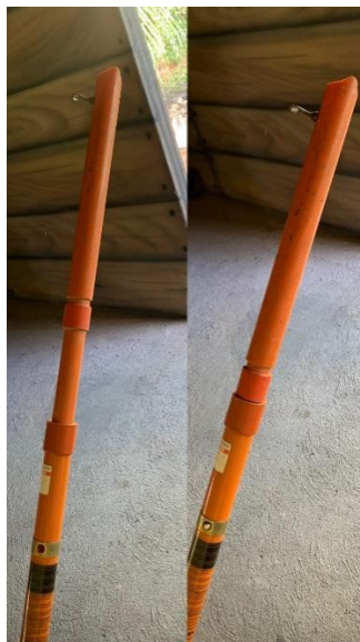
Figura 16 - Acoplamento Do Alçador na Vara
