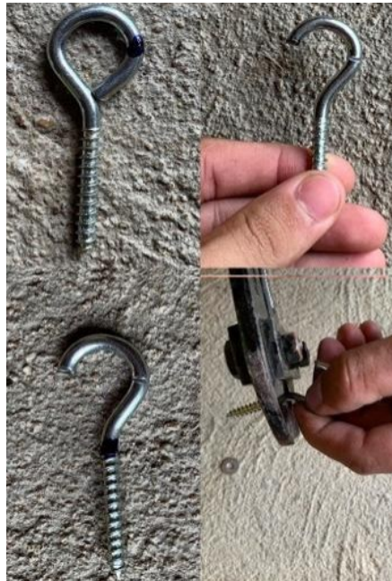
Figura 9 - Marcações e Cortes no Gancho Parafuso
