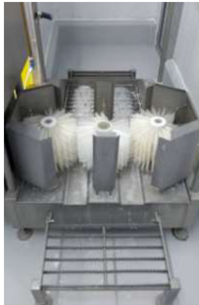
Figura 33 – Máquina lavadora de botas automática na entrada para a indústria
