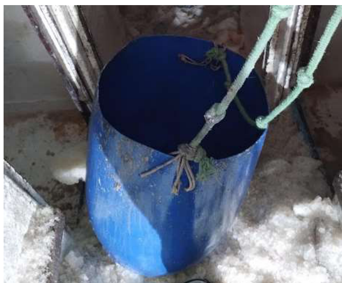
Figura 4 – Adaptação feita em bombona para realizar a retirada do pescado de dentro da embarcação
