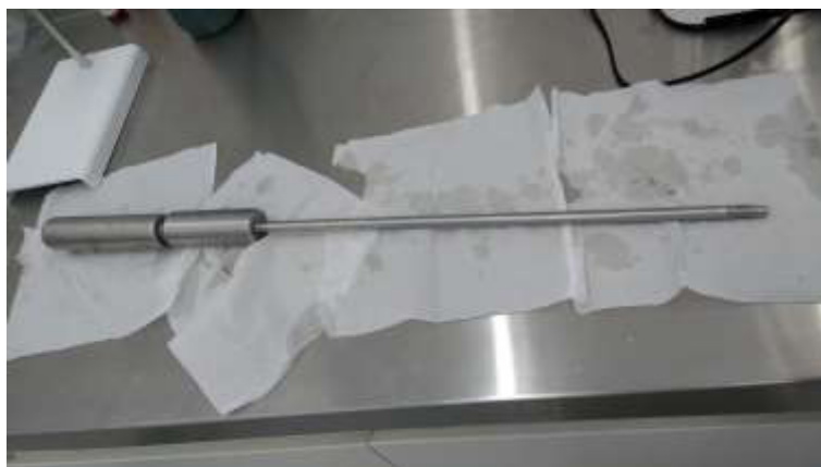
Figura 31 – Sashibo utilizado para retirar amostras de músculo de atum
