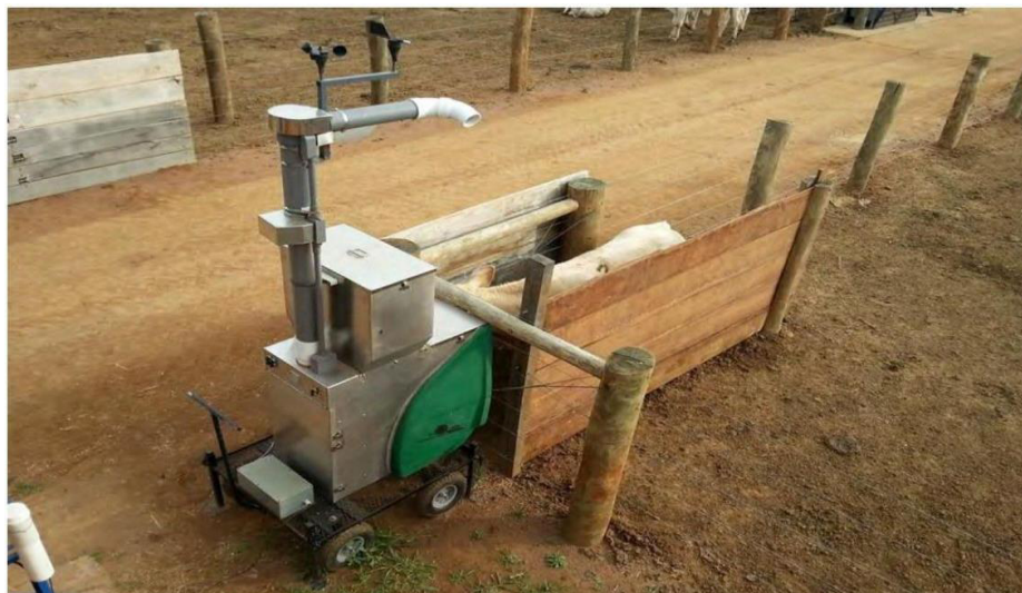
Figura 4 - Câmara de cabeça para amostragens pontuais(GreenFeed®).
