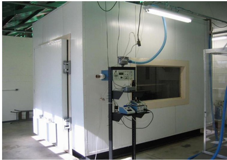
Figura 1 - Câmara respirométrica utilizada para bovinos.
