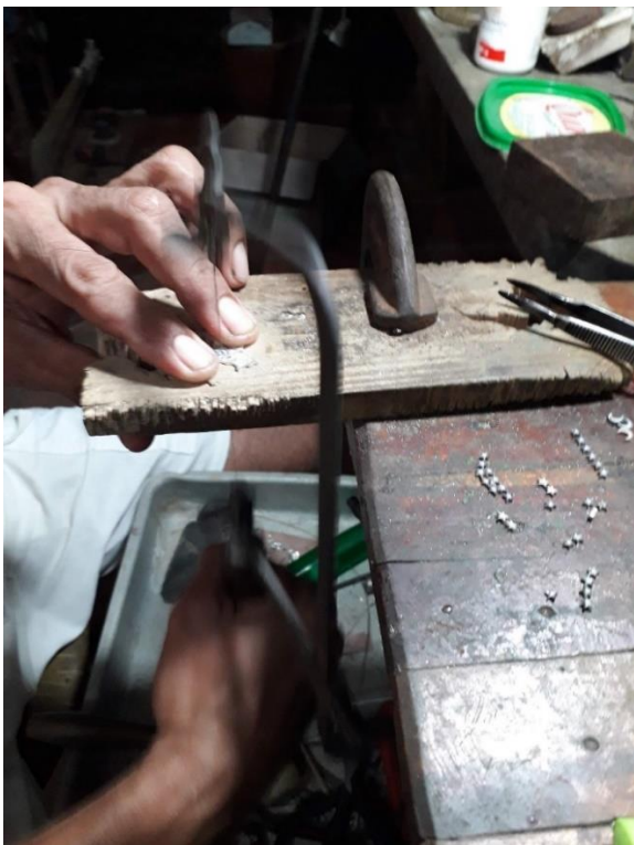
Figura 31: Artesão de Prata desenhando as peças com a serra de calar. Março 2019. Foto: Autor.
