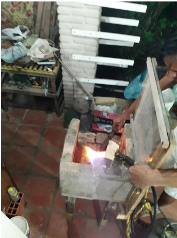
Figura 30: Artesão de Prata em Canoa, na sua oficina caseira na varanda de sua casa, no caso, fundindo a prata para iniciar processo de laminação. Março 2019 (foto Autor).
