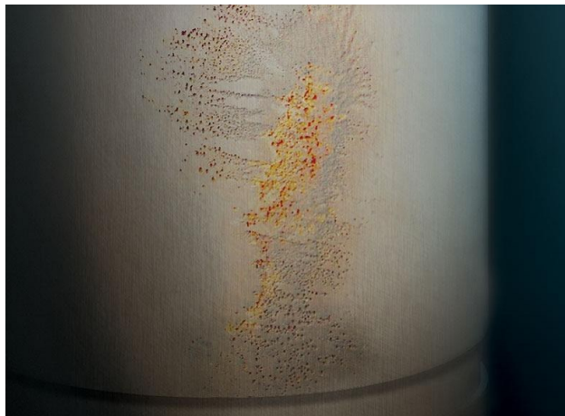
Figura 7: Corrosão em cilindro de veículo diesel
