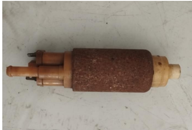
Figura 26: Bomba de combustível
