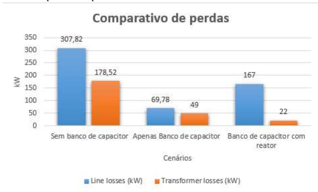
Figura 58 – Comparativo de perdas entre linhas e transformadores
