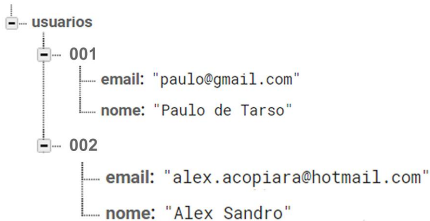
Figura 2 – Estrutura de banco dados Firebase
