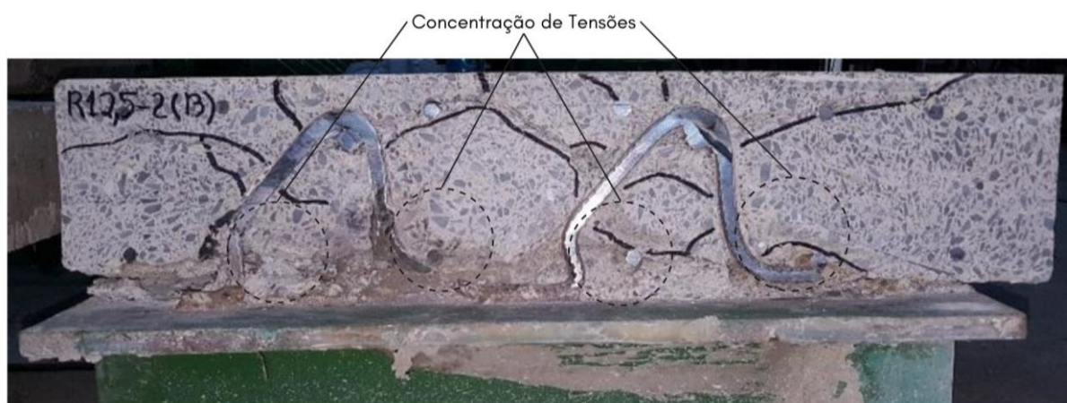
Figura 4.19 – Concentração de tensões na base das hastas do conector R12,5 no ensaio experimental
