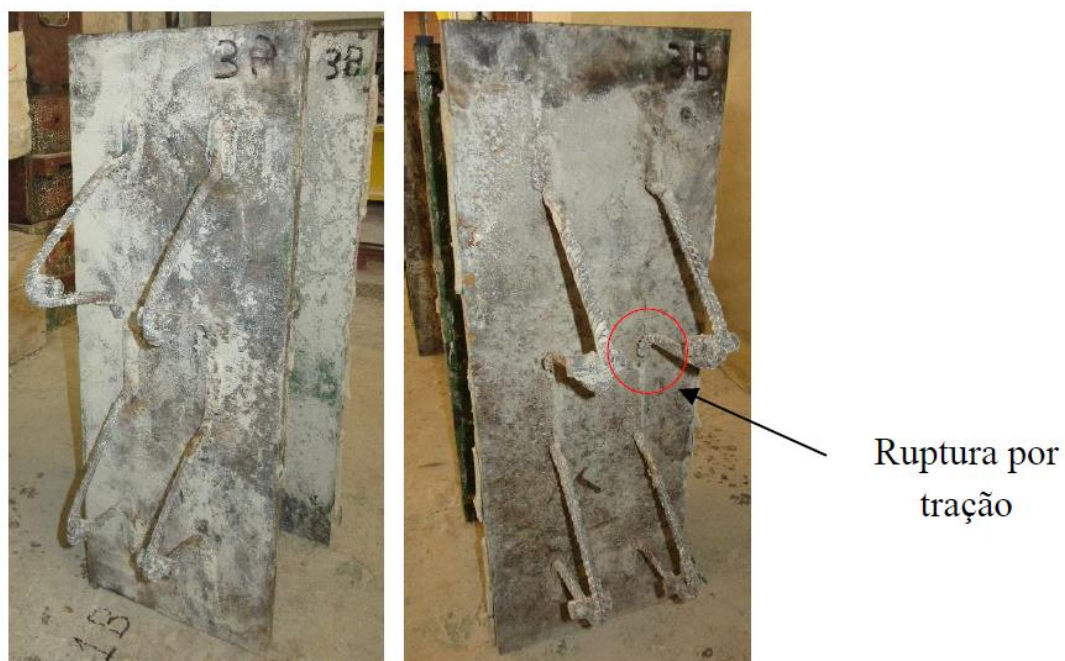
Figura 4.12 - Exemplo de ruptura por estrição no ensaio push-out para o conector reto R10
