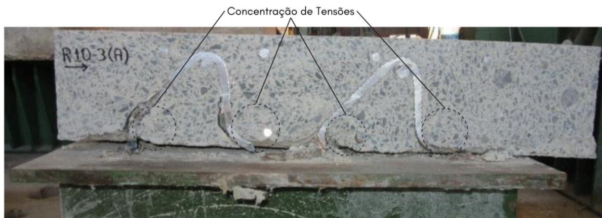
Figura 4.18 - Concentração de tensões na base das hastas do conector R10 no ensaio experimental
