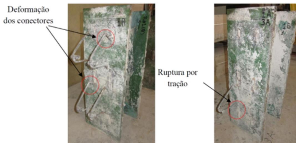
Figura 4.11 - Exemplo de ruptura por estricção no ensaio push-out para o conector reto R8
