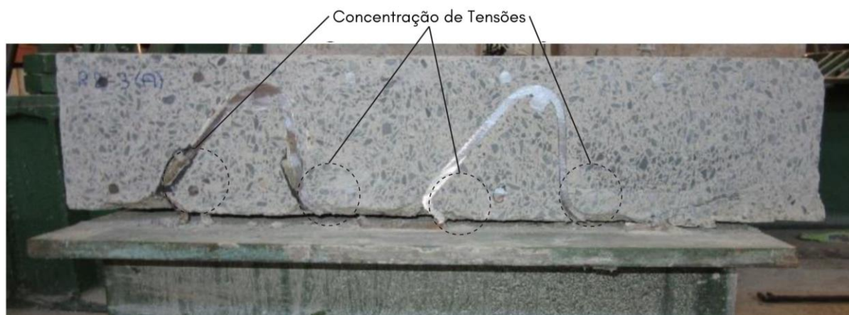
Figura 4.17 - Concentração de tensões na base das hastes do conector R8 no ensaio experimental
