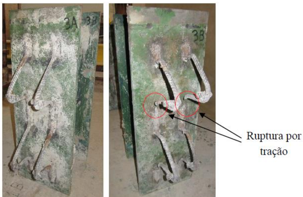
Figura 4.13 - Exemplo de ruptura por estrição no ensaio push-out para o conector reto R12,5
