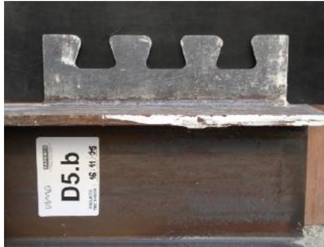
Figura 2.19 - Geometria do conector Crestbond
