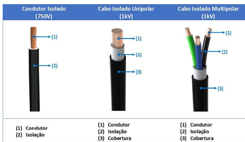
Figura 11 – Especificações técnicas de cabos da classe de tensão 0,6/1kV
