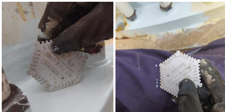
Figura 38 - Medição de Película Úmida de Acabamento.
