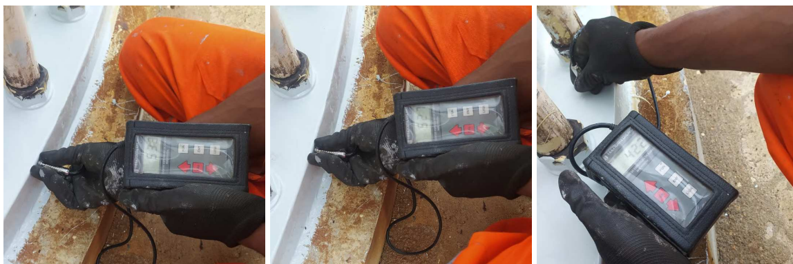
Figura 41 - Medição de Película Seca Final.
