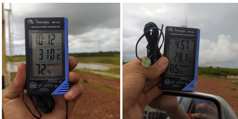
Figura 43 - Registro de Medições de Umidade.
