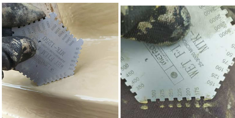
Figura 32 - Medição de Película Úmida Tinta de Fundo.
