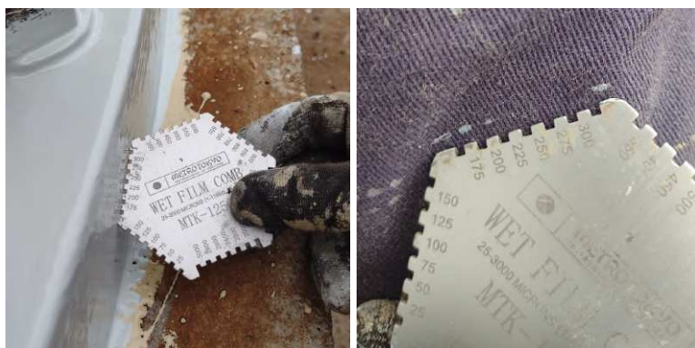
Figura 39 - Medição de Película Úmida de Acabamento.
