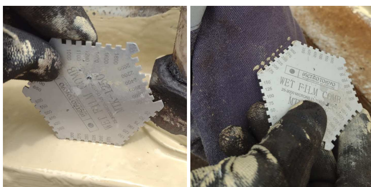
Figura 33 - Teste de Película Úmida Tinta de Fundo
