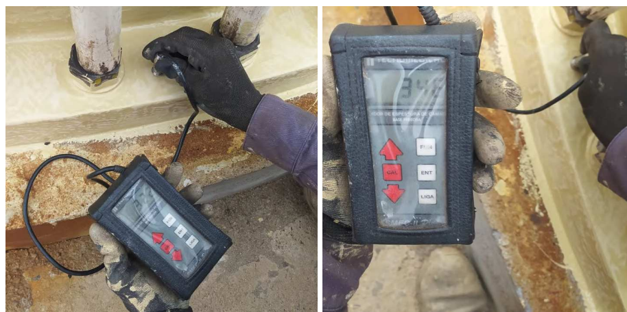
Figura 35 - Medição de Película Seca de Fundo.
