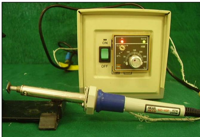
**FIGURA 4** – Ferro de soldar modificado e termostato.
