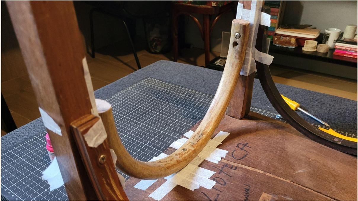
Figura 57 - Fixação do arco e preparação para a pintura
