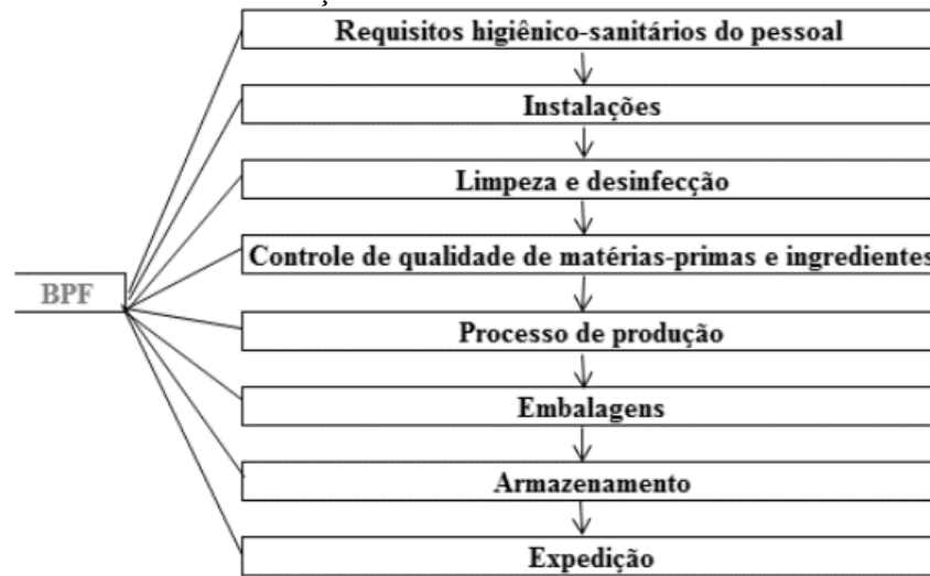
Figura 4 – Representação do fluxograma de boas práticas de fabricação, BPF em uma fábrica de ração
