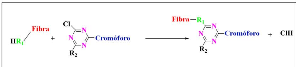
Figura 5 – Reação entre o corante reativo e as fibras têxteis.
