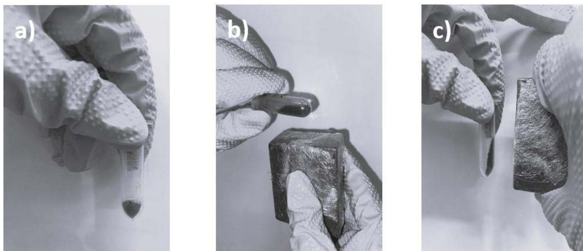
Figura 47 – Fotografias das amostras de MNP@CHI-GLU-LAC: (a) na ausência de um imã, (b) após a aproximação de um imã por 30s na horizontal e (c) após a aproximação de um imã por 30s na vertical.
