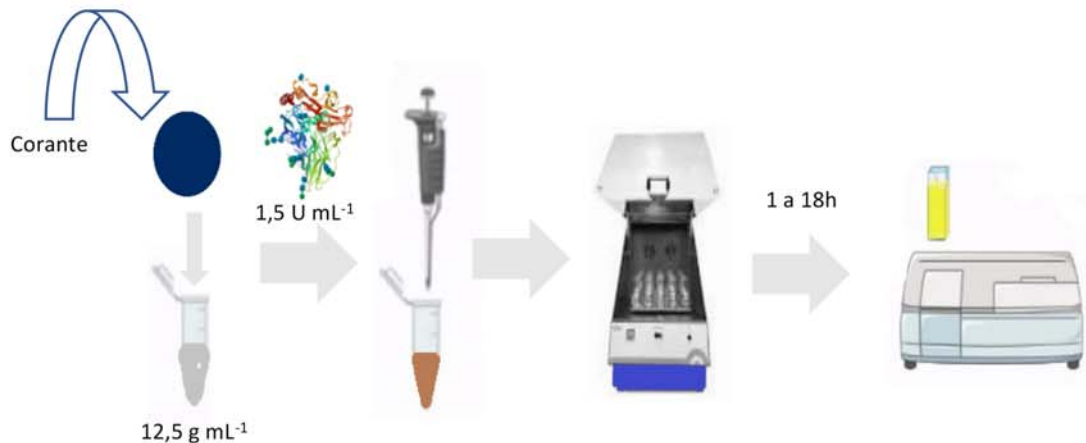
Figura 23 – Ilustração esquemática do ensaio de degradação de corante RB19
