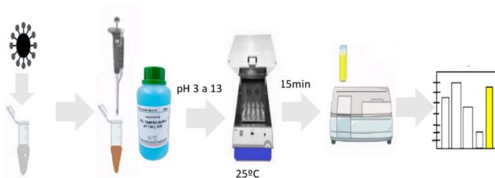
Figura 35 – Ilustração esquemática do estudo do efeito do pH na Lacase solúvel e imobilizada.
