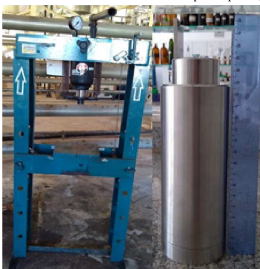
Figura 14 - Prensa hidráulica a frio e molde utilizado para a produção dos briquetes.
