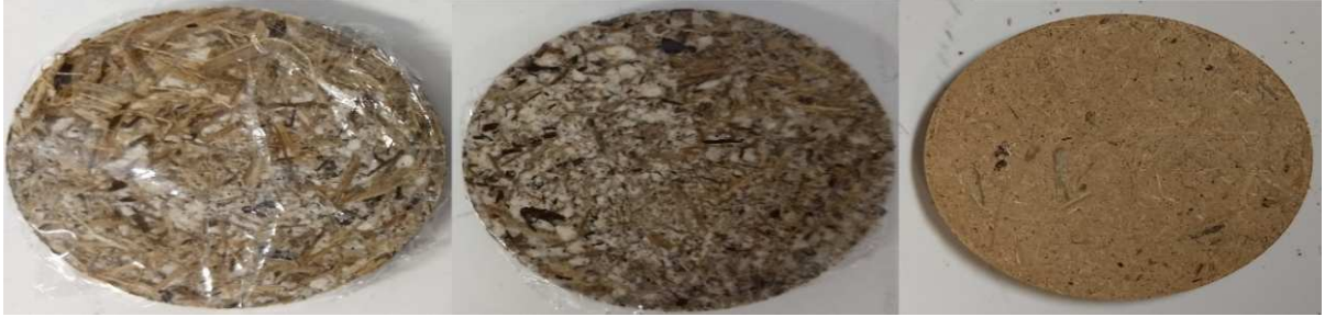
Figura 19 - Brique de do Torta Residual de babaçu com a palha de carnaúba, o talo de carnaúba e ambos.
