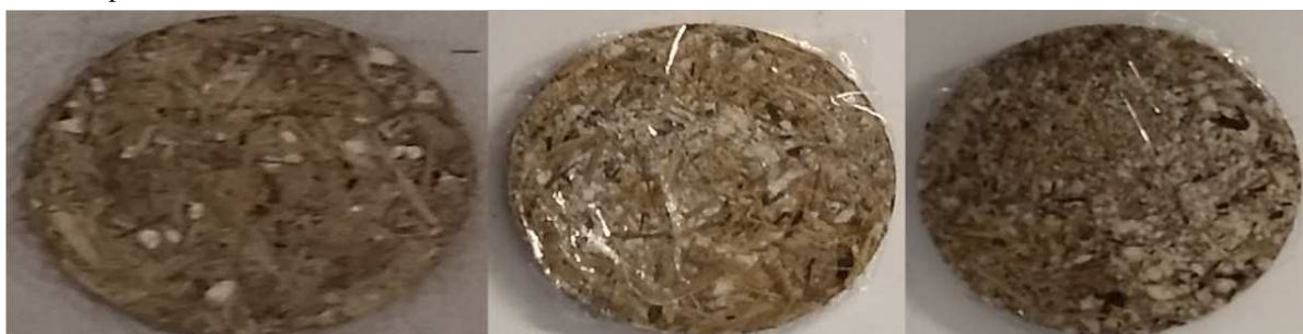
Figura 18 - Briquete do Torta Residual de babaçu e o bagaço de cana-de-açúcar, nas proporções 25%,50%, e 75%, respectivamente.
