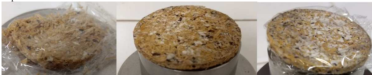
Figura 16 - Briquete do Torta Residual de babaçu e a casca de arroz, nas proporções 25%,50%, e 75%, respectivamente.
