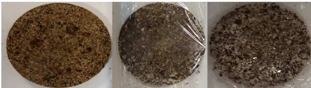
Figura 17 - Briquete do Torta Residual de babaçu e a casca de castanha, nas proporções 25%,50%, e 75%, respectivamente.
