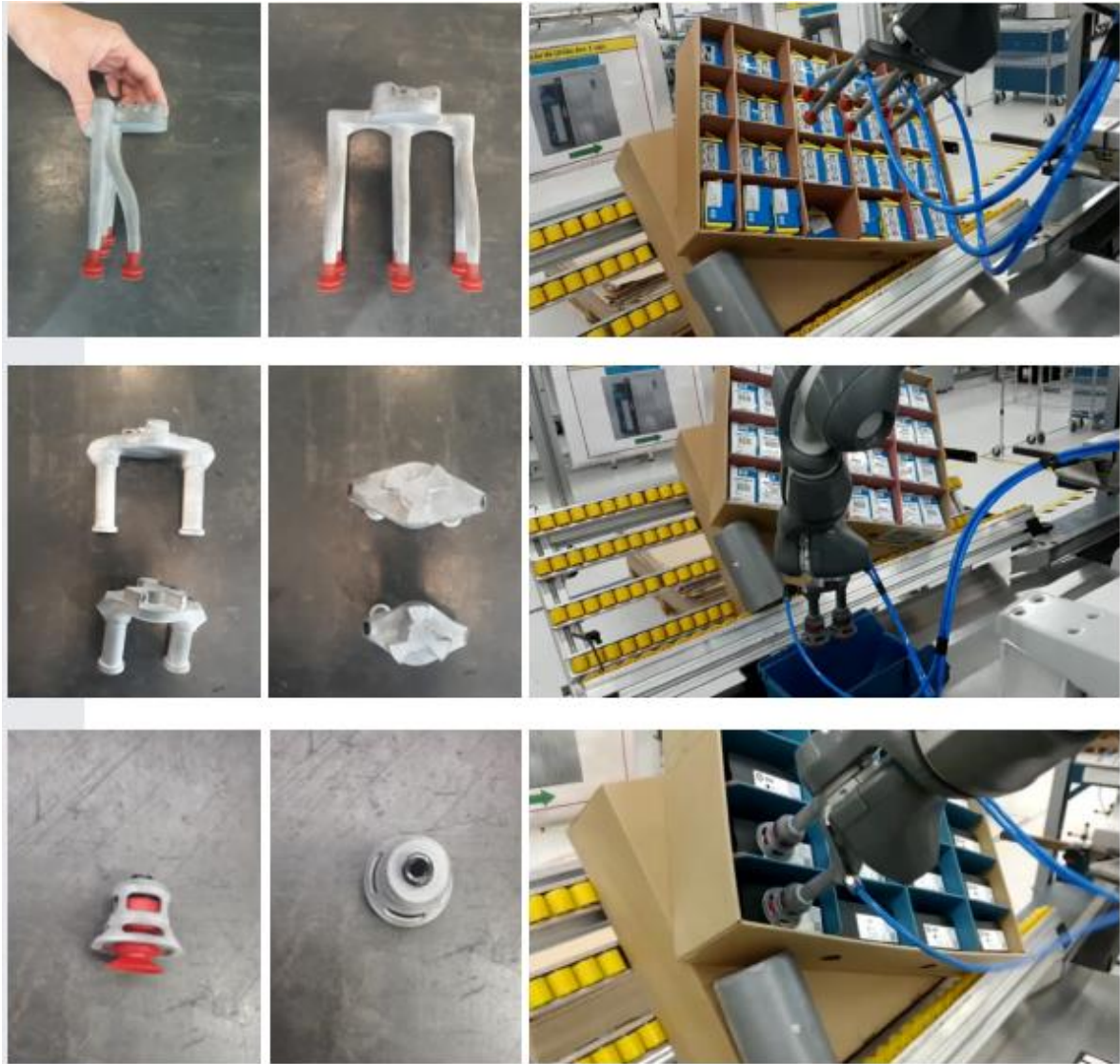
Figura 9 - Braço robótico desenvolvido com o auxílio de uma impressora 3D.
