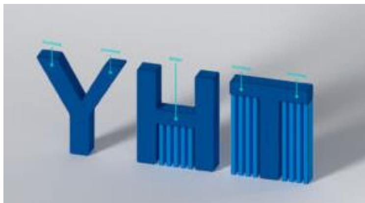
Figura 8 - Presença de estruturas de apoio.
