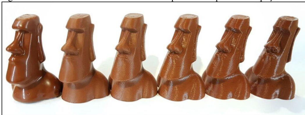
Figura 15: Influência da altura de camada na qualidade superficial de peças.
