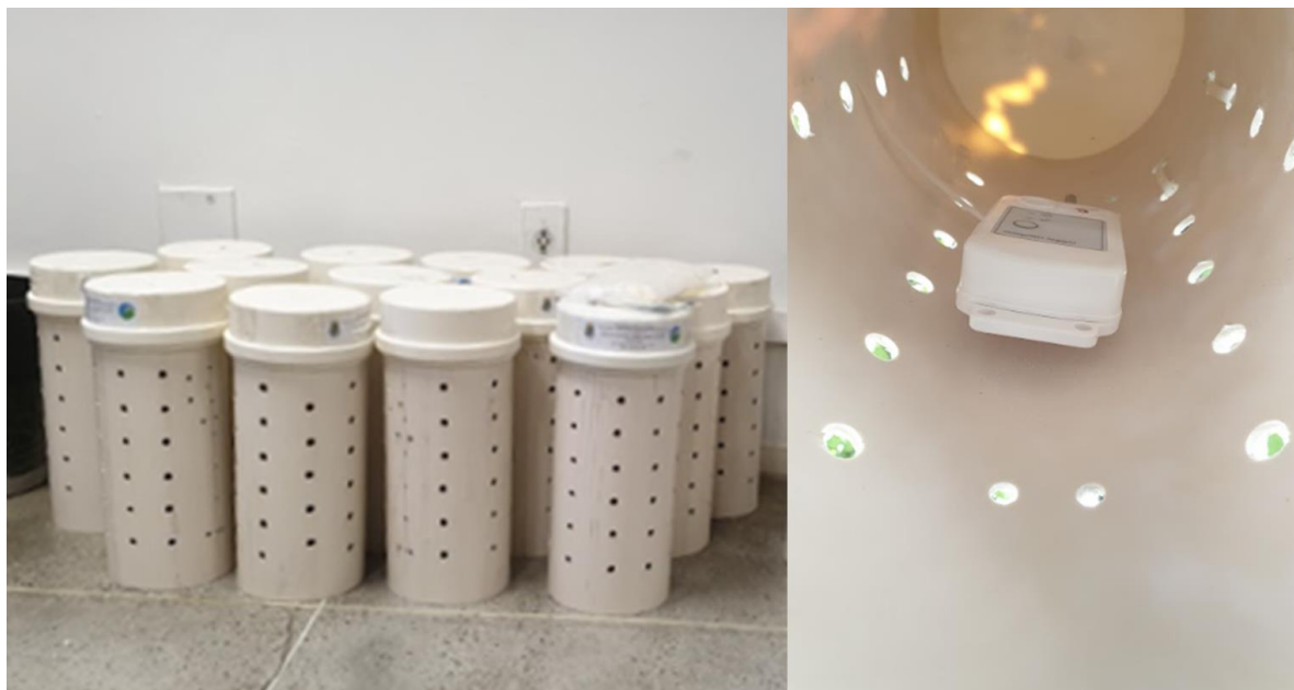
Figura 18 – Abrigo de PVC para os termo higrômetros
