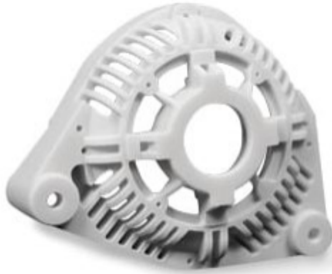
Figura 25 - Mancal de alternador veicular fabricado por impressora 3D
