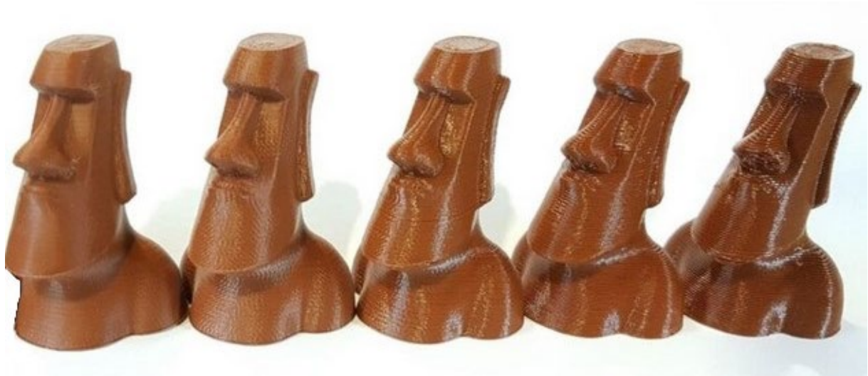
Figura 16 - Efeito da altura de camada no acabamento superficial
