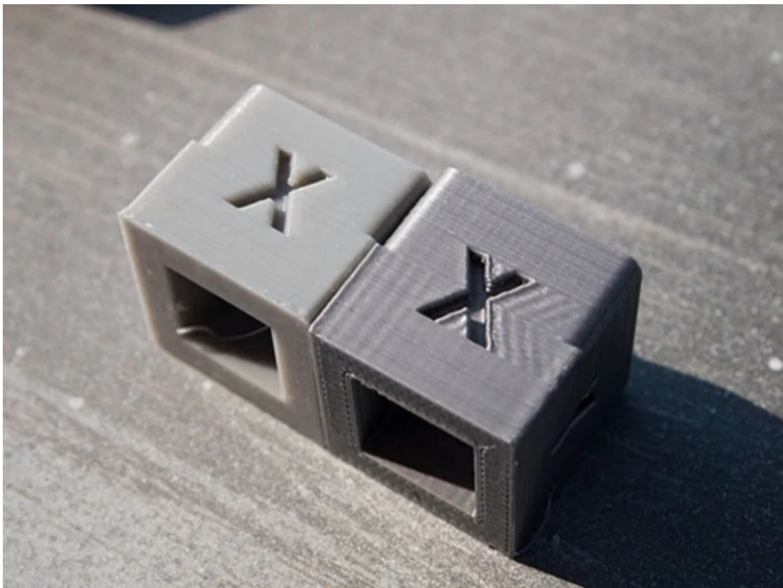
Figura 19 - Efeito da velocidade de impressão no acabamento superficial
