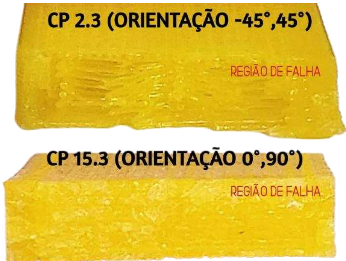
Figura 58 – Regiões internas dos CPs após a ruptura
