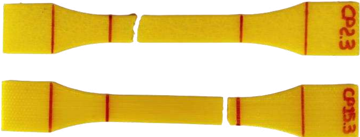
Figura 57 – Direção de falha diagonal e perpendicular para o PETG
