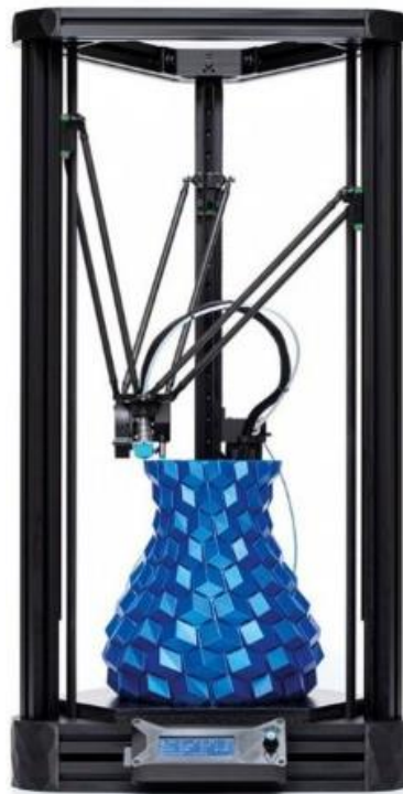
Figura 13 – Impressora 3D tipo delta
