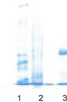
FIGURA 10: Eletroforese em gel de poliacrilamida (12,5 %) na presença de SDS e \beta -mercaptoetanol de A. multifida . (1) marcadores de massa molecular: lactoalbumina, 14,2 kDa; inibidor de tripsina, 20,1 kDa; tripsinogênio 24,0 kDa; anidrase carbônica, 29,0 kDa; gliceraldeído-3-fosfato desidrogenase, 36,0 kDa; ovoalbumina, 45,0 kDa e albumina sérica bovina, 66,0 kDa. (2) fração F0/70 e (3) PI-DEAE.
