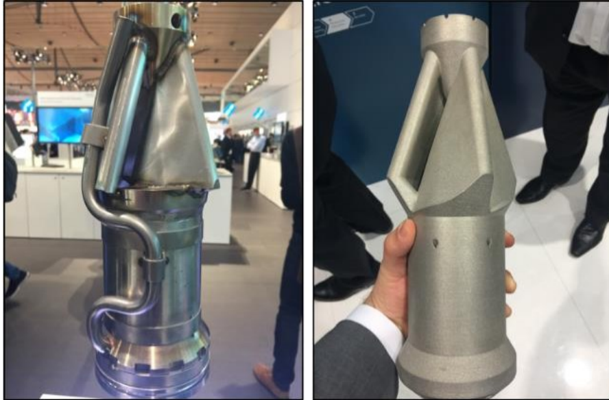
Figura 17 – Turbina de gás produzida por manufatura convencional à esquerda, e por manufatura aditiva à direita
