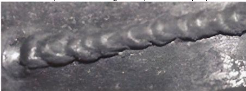
Figura 39 – Defeitos encontrados em cordões de solda fabricados por deposição a arco: a) cordão não homogêneo e b) excesso de deposição
