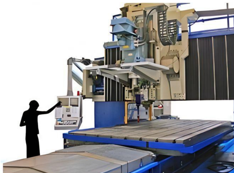
Figura 30 – Máquina controlada por computador, usando sistema de soldagem do tipo MIG
