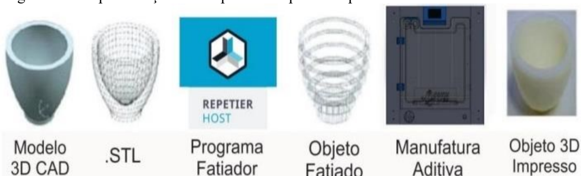
Figura 12 – Representação das etapas de um processo por MA
