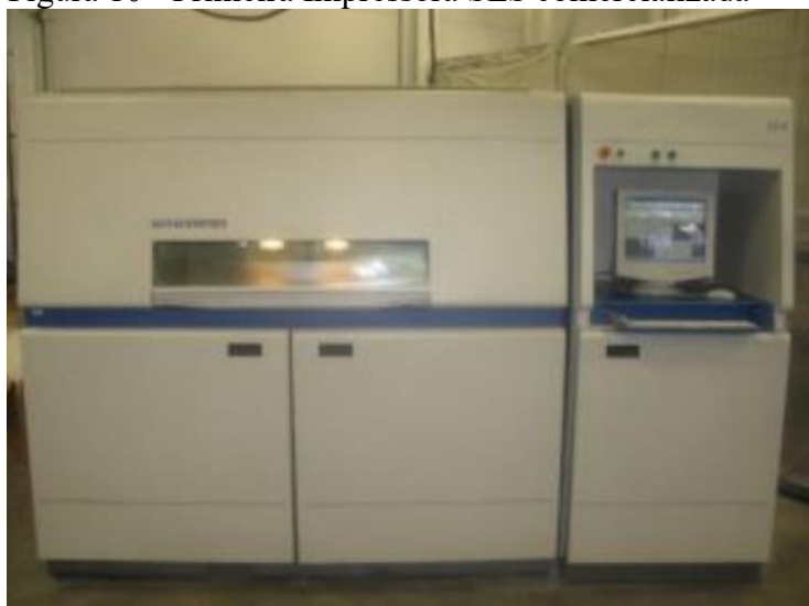
Figura 10 - Primeira Impressora SLS comercializada
