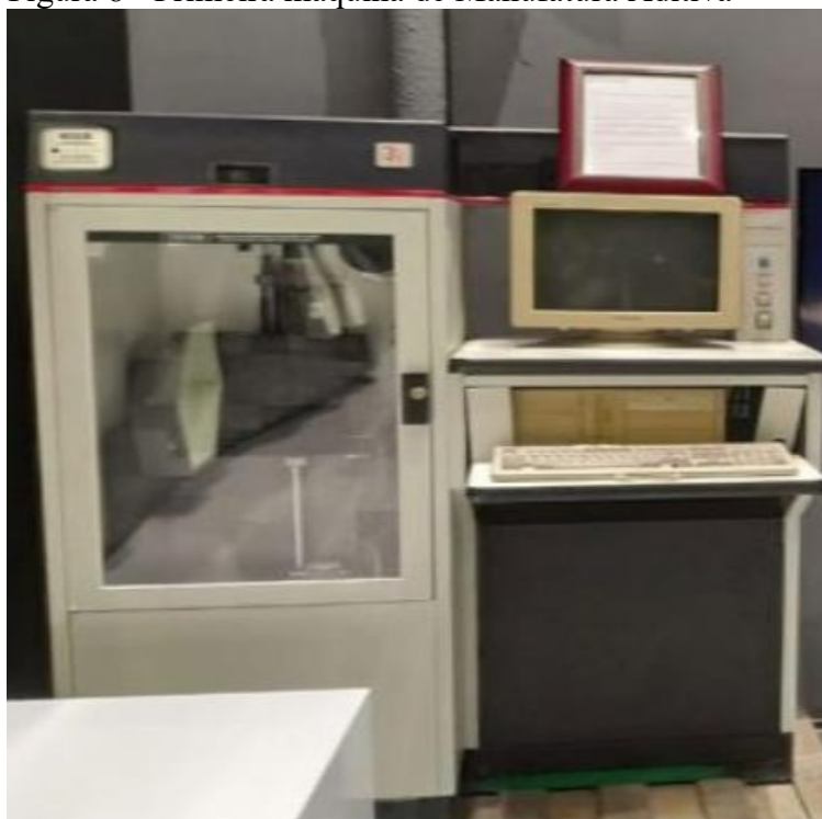
Figura 8 - Primeira máquina de Manufatura Aditiva
