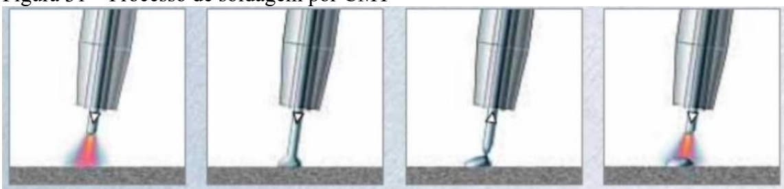
Figura 31 – Processo de soldagem por CMT
