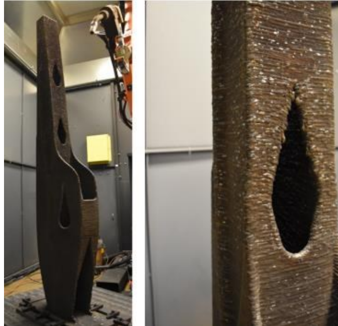
Figura 41 – Braço de retroescavadeira impresso por MADA
