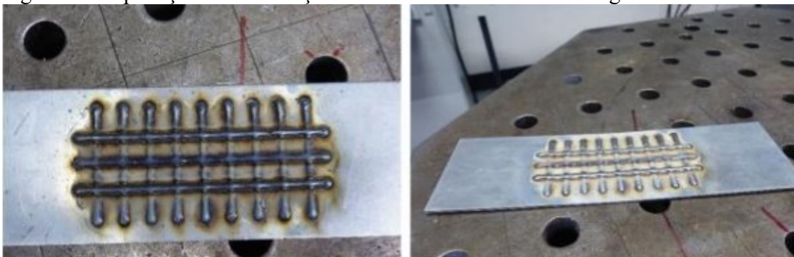
Figura 40 - Aplicações de fabricação aditiva baseada em arco na engenharia automotiva
