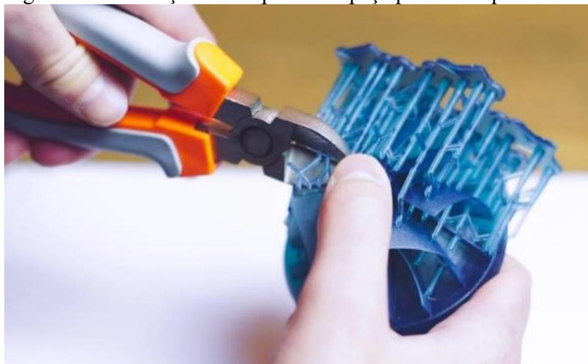
Figura 15 – Remoção dos suportes de peça produzida por MA
