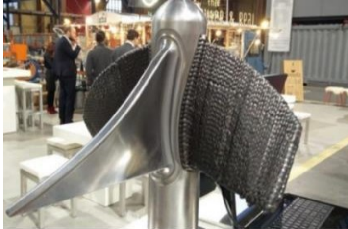
Figura 45 - Propulsor marítimo fabricado utilizando MADA
