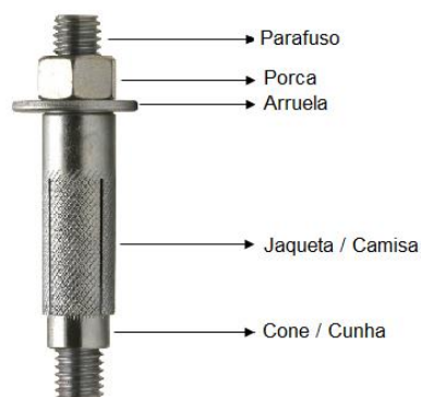
Figura 8 - Chumbador Mecânico - Componentes.
