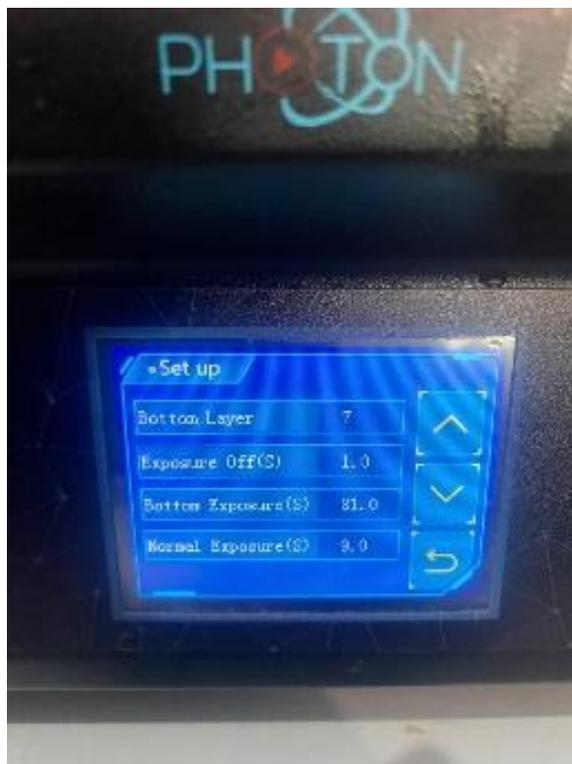
**Foto 3.** Dados do Monitor da Impressora 3D Anycubic Photon
