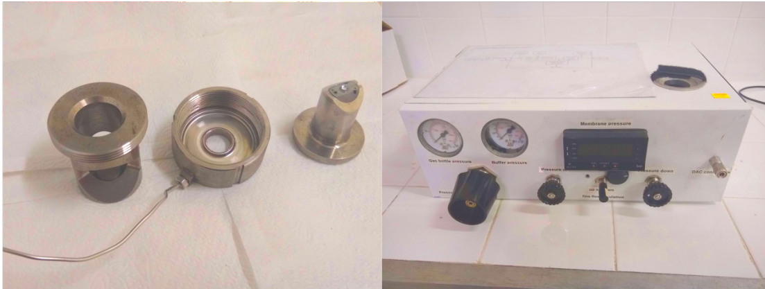
Figura 14 – À esquerda, a célula de pressão aberta e, à direita, câmara de pressão.
