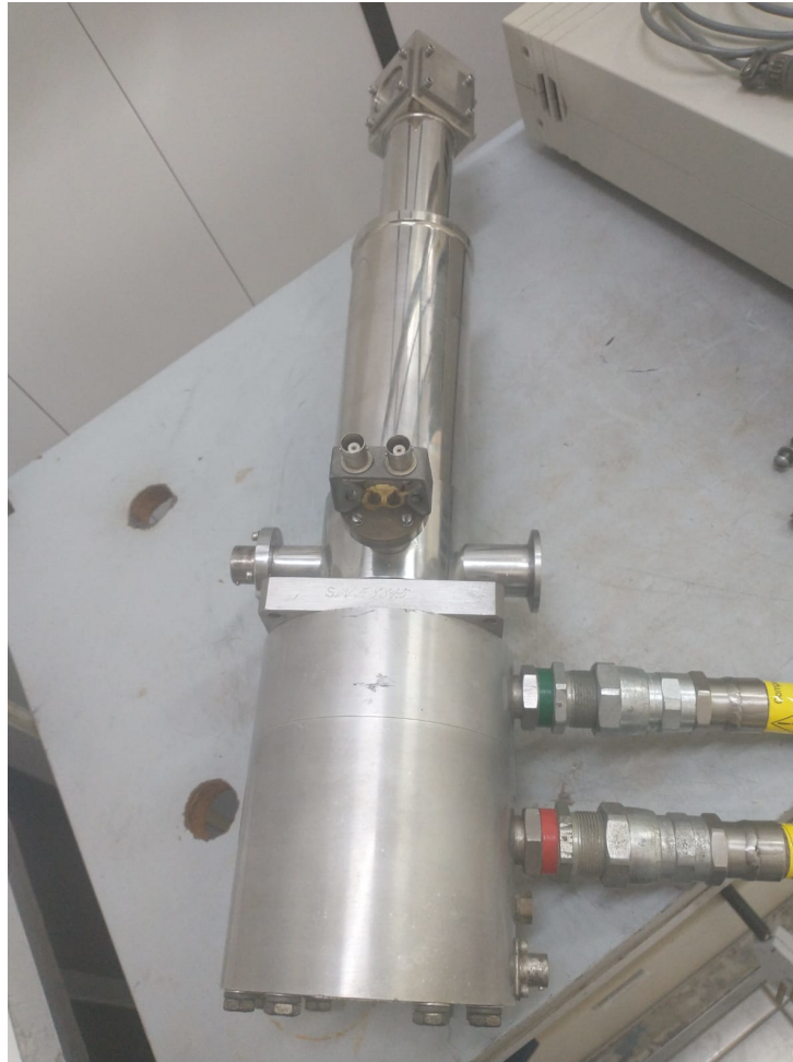
Figura 12 – Criostato utilizado para o experimento de espectroscopia Raman no ácido maleico em baixas temperaturas.
