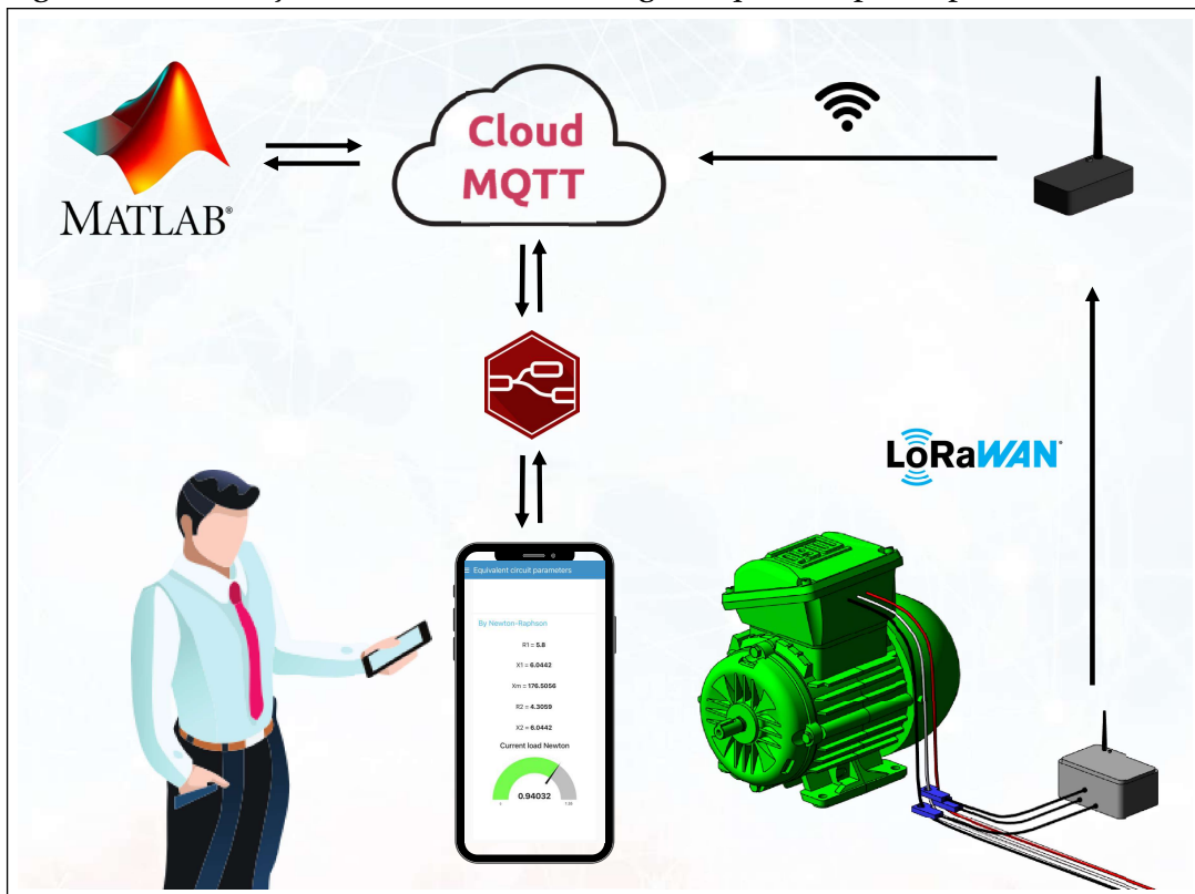
Figura 11 – Interação dos recursos tecnológicos que compõem plataforma IIoT
