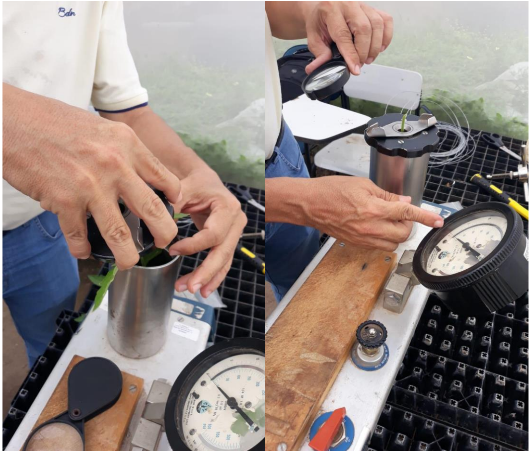
Figura 07. Bomba de Scholander sendo utilizada para aferição do potencial hídrico das folhas.
