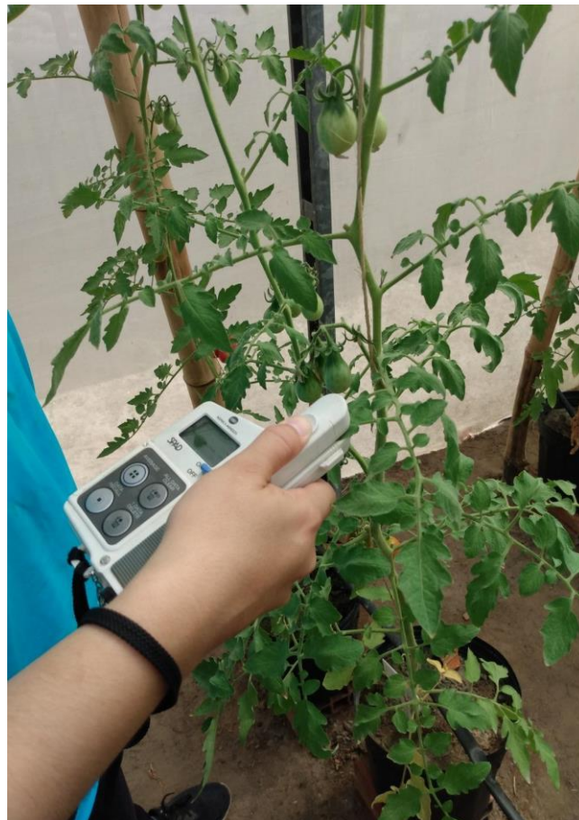
Figura 06. SPAD para coleta de unidades de clorofila das plantas de tomate cereja
