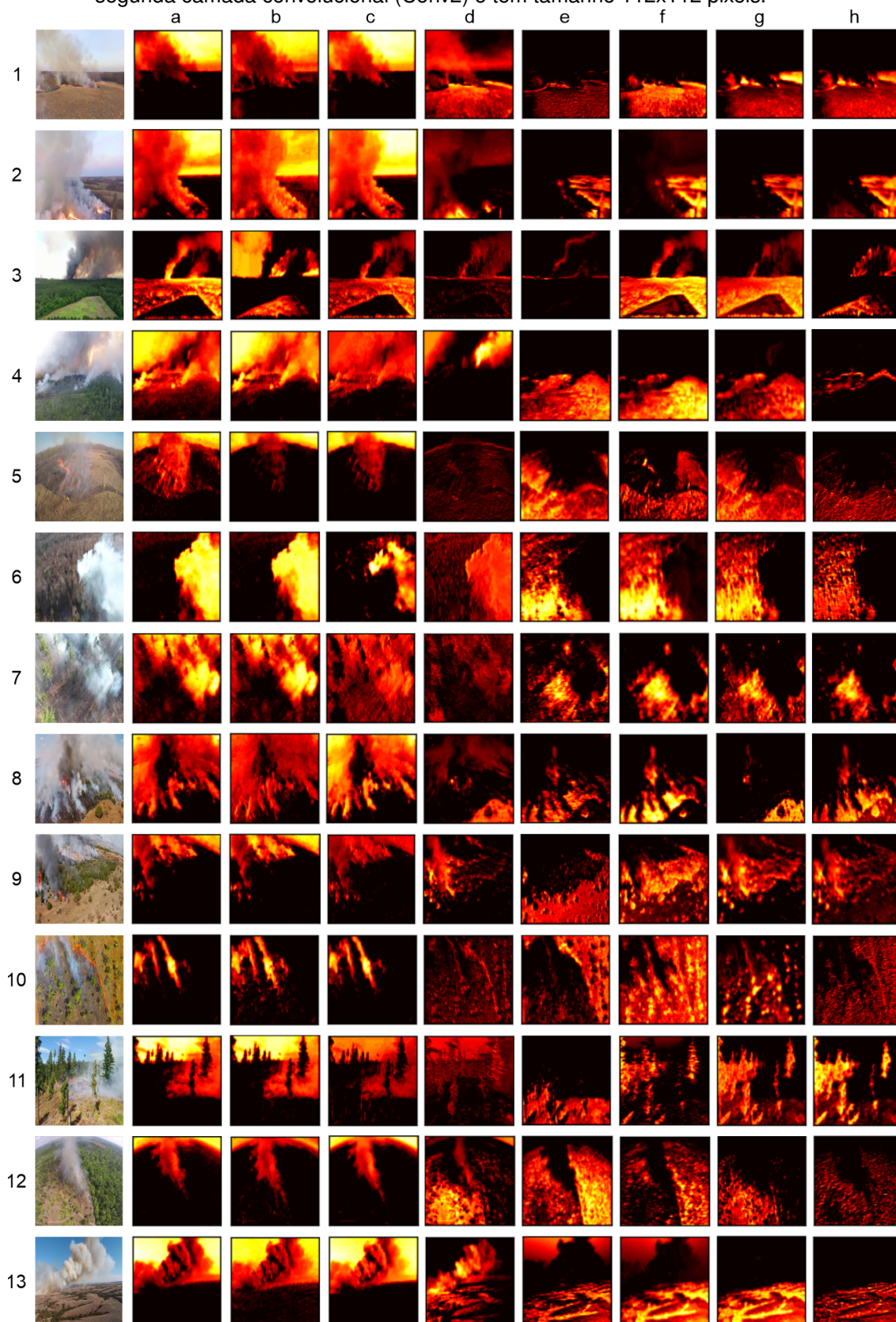
Figura 25 – Amostras da classe ICFF [1-13] e os oito principais mapas de características [a-h] da EdgeFireSmoke (SILVA et al. , 2022; ALMEIDA et al. , 2023). Os mapas [a-d] são da primeira camada convolucional (Conv1) e têm tamanho 224x224 pixels. Os mapas [e-h] são da segunda camada convolucional (Conv2) e têm tamanho 112x112 pixels.
