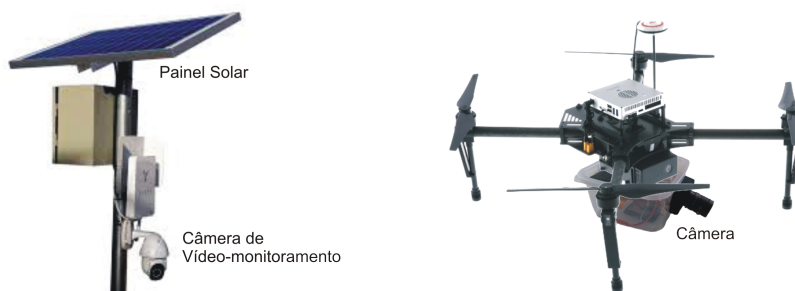
Figura 17 – Ilustração dos sistemas de monitoramento de incêndio florestal: (a) torre de monitoramento autosuficiente com energia solar; (b) Veículo aéreo de vigilância.
