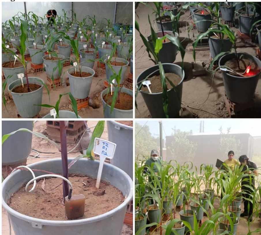
Figura 19 - Sensores de umidade instalados nos vasos do experimento.
