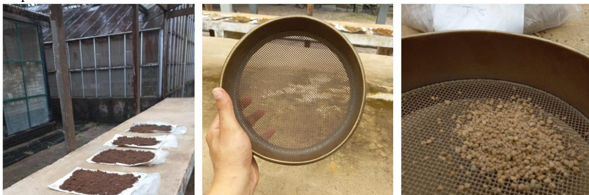
Figura 9 - Amostras secando em casa de vegetação, detalhe da malha da peneira utilizada e do peneiramento.
