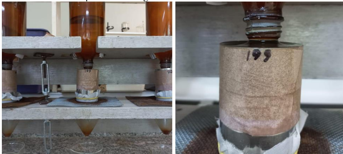
Figura 16 - Amostra sob observação e detalhe do cilindro de carga sobre a amostra em contato com recipiente de recarga hidráulica.
