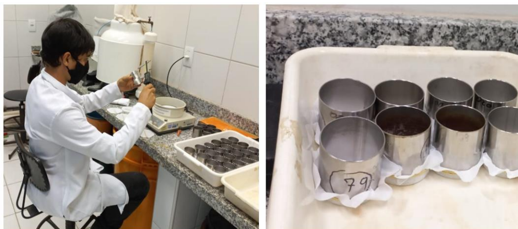
Figura 10 – Preparo e mensuração dos cilindros metálicos para coleta de amostras indeformadas de solo-substrato.
