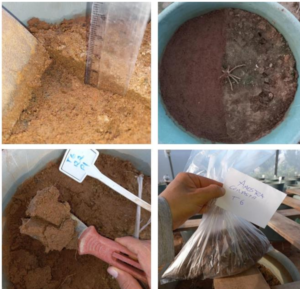
Figura 8 - Retirada da camada superficial de 1 cm e das amostras compostas de solo-substrato depositadas em sacos plásticos.
