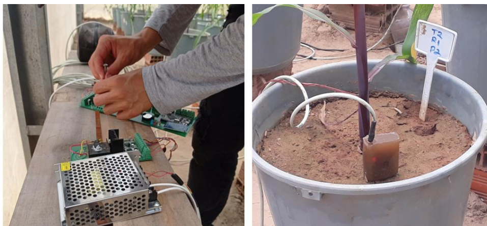
Figura 21 – Instalação do conjunto de componentes do datalogger e detalhe para o sensor de umidade inserido no vaso.
