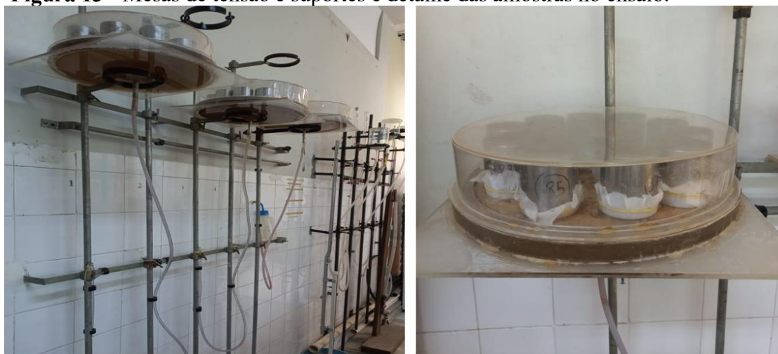
Figura 13 - Mesas de tensão e suportes e detalhe das amostras no ensaio.
