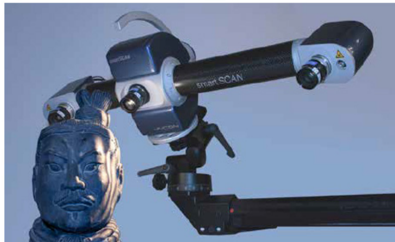
Figura 4 - Digitalização por luz estruturada de uma escultura.
