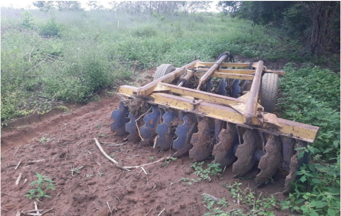
Figura 9. Grade baldan com 20 x 28 polegadas. Arame (MA), 2020.
