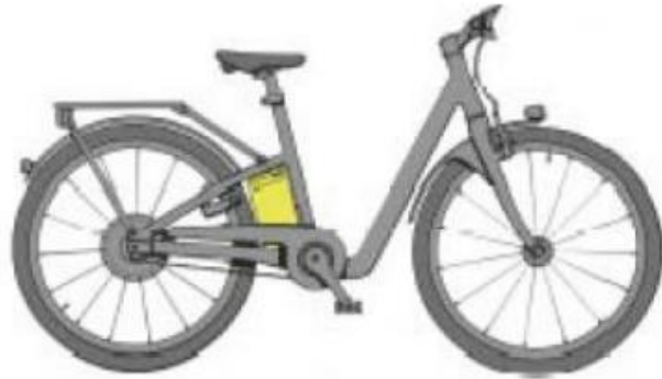
Figura 11 - Baterias alojadas no quadro.
