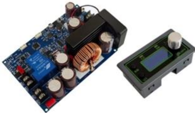
Figura 24 - Regulador de tensão para o circuito do tapete gerador.
