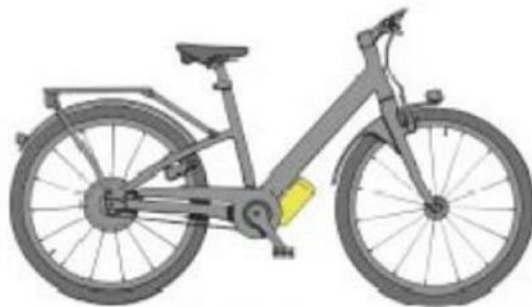
Figura 9 - Motor alojado diretamente no movimento central.
