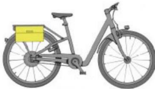
Figura 10 - Baterias alojadas no rack traseiro.
