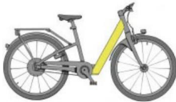
Figura 12 - Bateria alojada dentro do tubo inferior.
