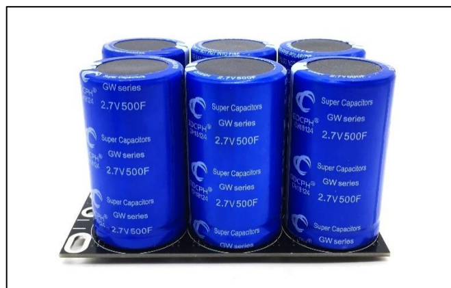
Figura 21 - Super capacitor de 16V e 500F.
