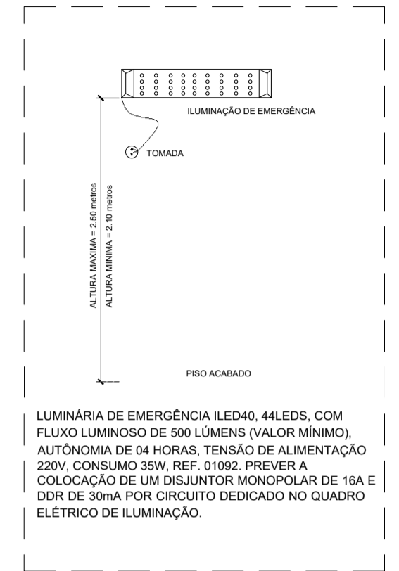
11 DET. LUMINÁRIA DE EMERGÊNCIA ESCALA: S/E
