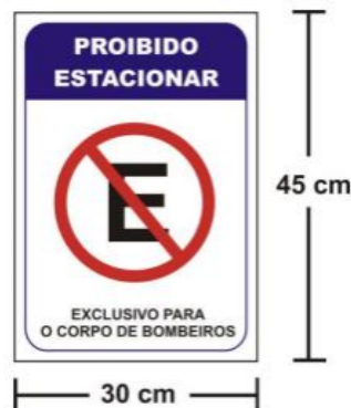
Figura A 9. Placa de vaga reservada para viaturas do Corpo de Bombeiros.
