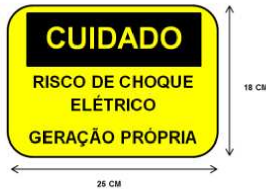
Figura 17 - Placa de advertência - “CUIDADO – RISCO DE CHOQUE ELÉTRICO – GERAÇÃO PRÓPRIA”
