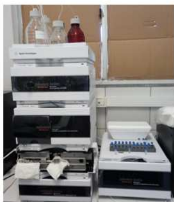
Figura 25 – Configurações do cromatógrafo líquido acoplado a detector de arranjo de diodos (CLAE-DAD) utilizado para análise das flores de lúpulo.
