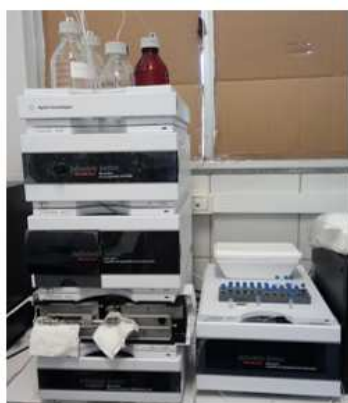
Figura 20 – Configurações do cromatógrafo líquido acoplado a detector de arranjo de diodos para análises frente ao sistema hipoxantina/xantina oxidase.
