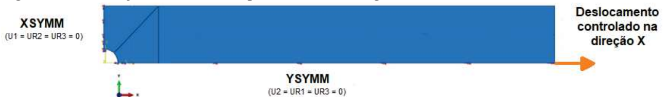
Figura 35 – Condições de contorno aplicadas na modelagem.
