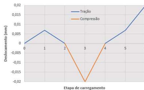
Figura 28 – Sequência de deslocamentos do caso cíclico.
