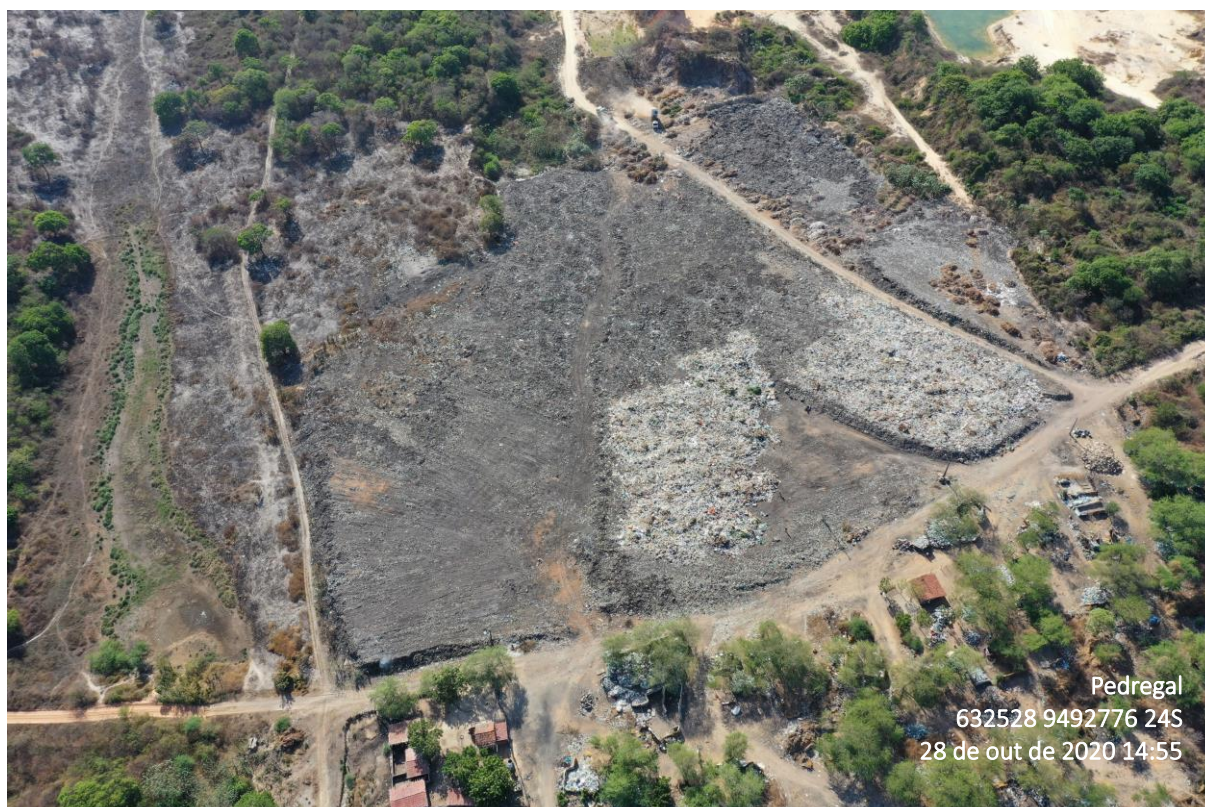
Figura 26 – Fotografia aérea obtida por drone em 28/10/2020 da disposição dos resíduos sólidos do município de Aracati – CE a céu aberto.
