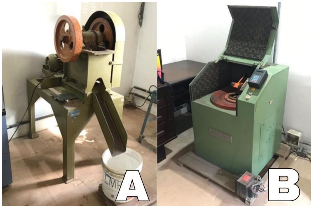
Figura 15: (A) Britador de mandíbulas; (B) Moinho pulverizador de panela
