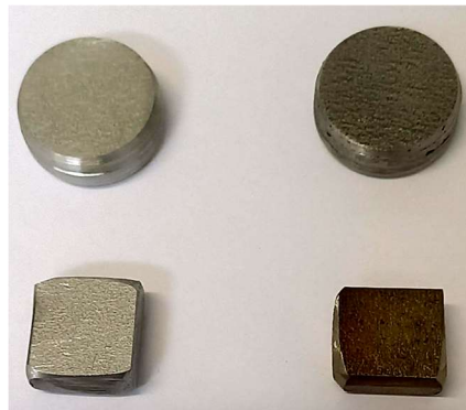
Figura 40 - Aço inox 316 L com eletropolimento (esquerda) e aço inox 316 L sem eletropolimento (direita).
